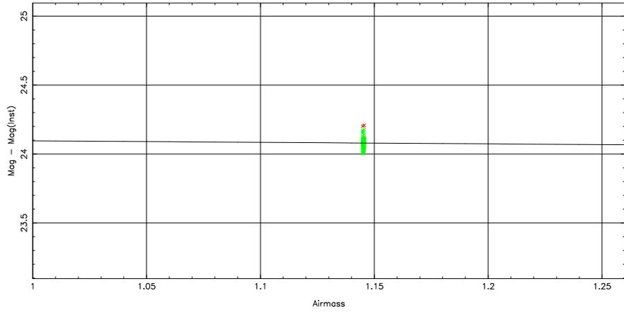
2 parameter fit:  $\text{Mag}-\text{Mag}(\text{Inst}) = 24.21 \pm 0.27 + (-0.11 \pm 0.00) \text{airmass} + (-0.18 \pm 0.00) \text{color}$
