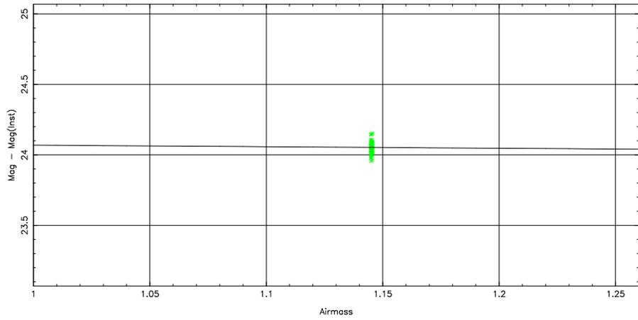
1 parameter fit:  $\text{Mag}-\text{Mag}(\text{Inst}) = 24.18 \pm 0.10 + (-0.11 \pm 0.00) \text{airmass} + (-0.13 \pm 0.00) \text{color}$
