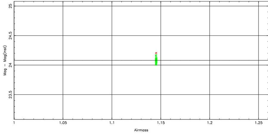
3 parameter fit:  $\text{Mag}-\text{Mag}(\text{Inst}) = 24.08 \pm 0.27 + (-0.00 \pm 0.00) \text{airmass} + (-0.18 \pm 0.46) \text{color}$
